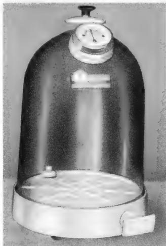
Vollständige Vakuumglocke, geeignet zum Tränken von Spulendickeln, mit Vakuummeter und Pumpe (im Unterteil)
