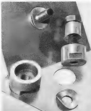
In 1 1/2 Min. werden mit dem Rekordlocher einwandfreie Löcher in Metall und alle Materialien gestanzt. Leichte Handhabung - nur mit gewöhnlichem Schraubenschlüssel. Standardgrößen von 10-61 mm Ø, ab 8.25 DM
