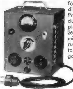
für Werkstatt und Kundendienst, Leistung: 300 VA, Pr. 110/125/150/220/240 V durch Schalter an d. Frontplatte umstellbar, Sek. 180-260V in 15 Stufen regelbar mit Glimmlampe und Sicherung. Dieser Transformator schaltet beim Regelvorgang nicht ab, daher keine Beschädigung d. Fernsehergerätes.
